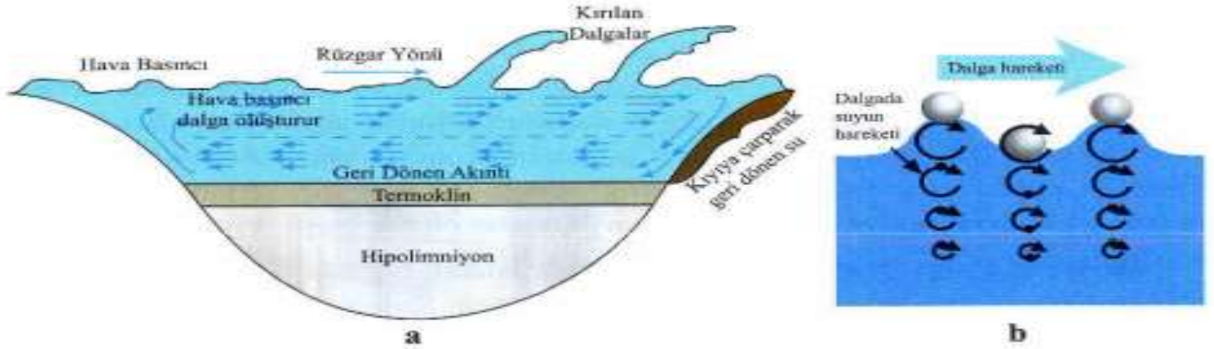
Şekil 3.18. a, Geri dönen akıntı; b, yatay hareket eden dalga ve dalga altındaki suyun hareketi.
